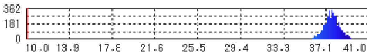
図－6 道路アスファルトの温度分布（横軸：温度，縦軸：画素数）
